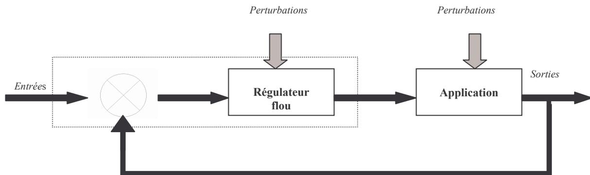
Schéma 1 : Graphe de fonctionnement du système de commandes de la serre agricole [1].
